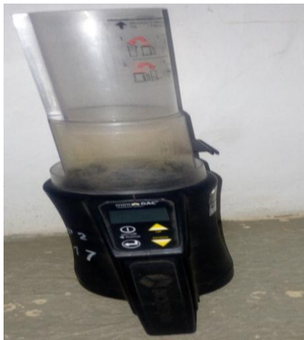
Multi-crop grain moisture meter
